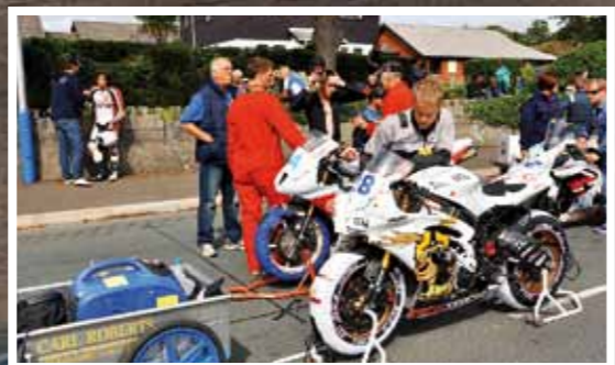
Čekání na start závodu Junior. Pneumatiky jsou ještě zabalené do ohřívačů, aby měly co nejlepší přilnavost.
